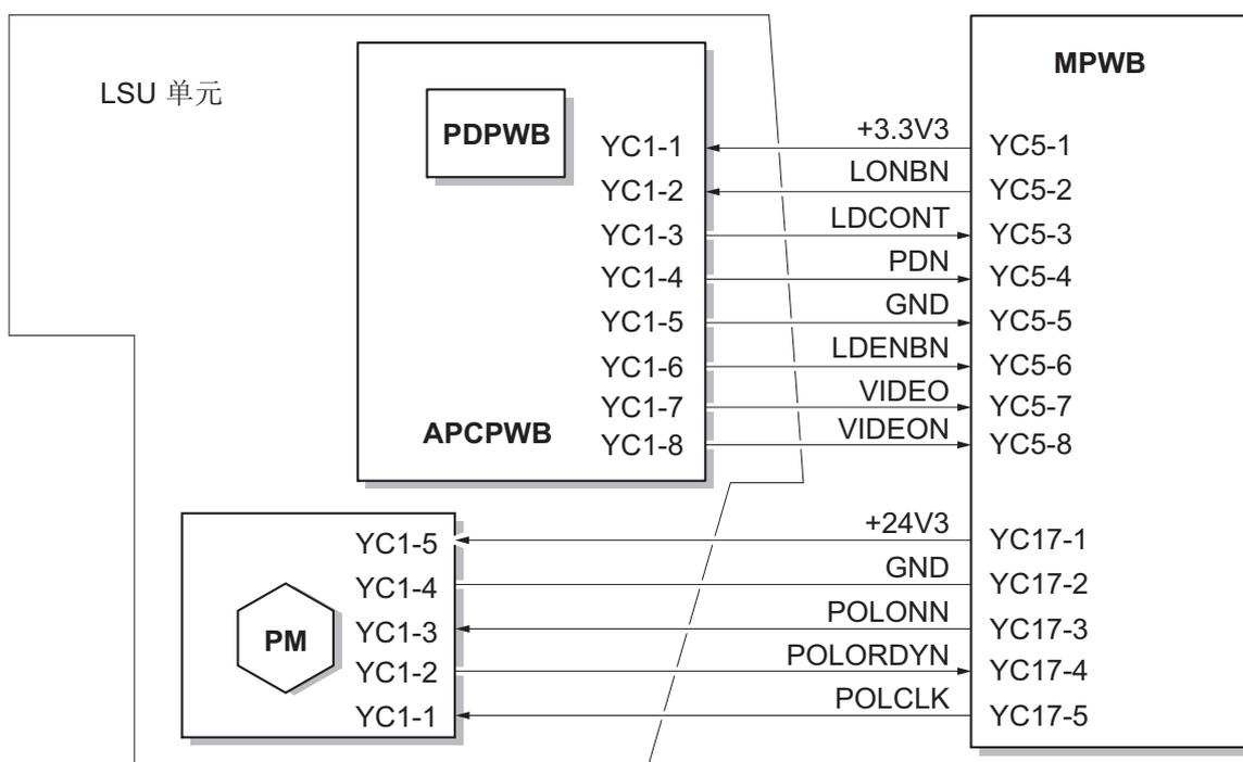
图 2-1-12 激光扫描仪单元框图
