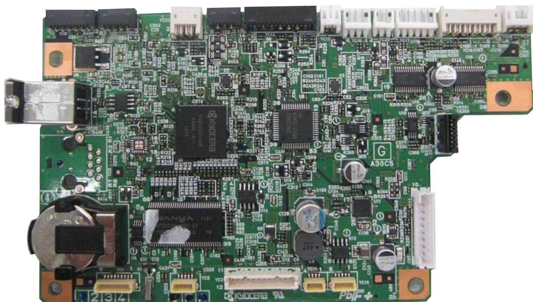
图 2-3-4 4 合 1 20/21 ppm 机型主控板
