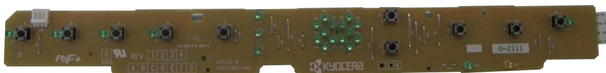
图 2-3-16 操作面板电路板
