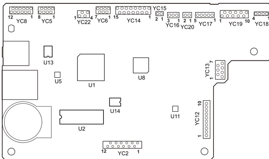
图 2-3-1 4 合 1 25/26 ppm 机型主控板丝印图
