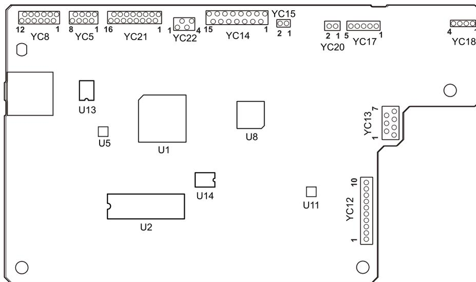
图 2-3-7 主控板丝印图
