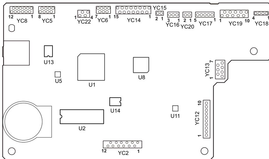
图 2-3-3 4 合 1 20/21 ppm 机型主控板丝印图
