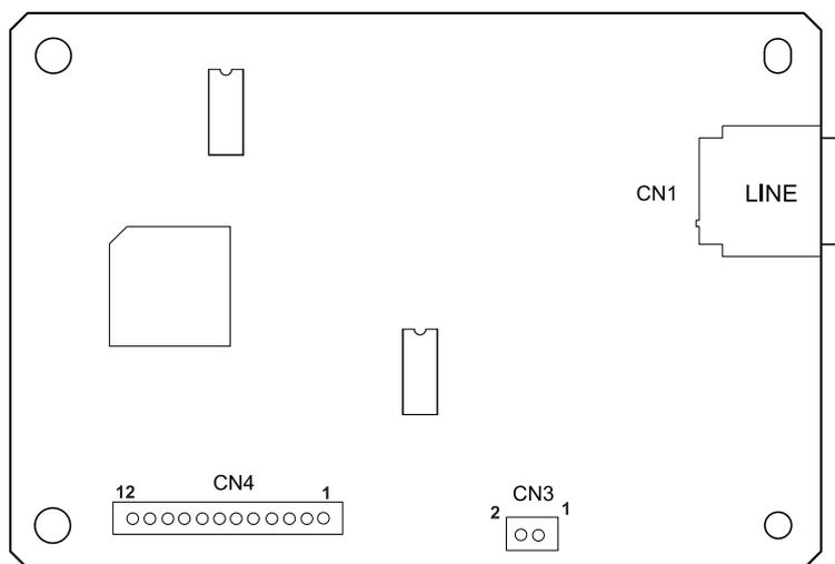
图 2-3-13 传真控制电路板丝印图
