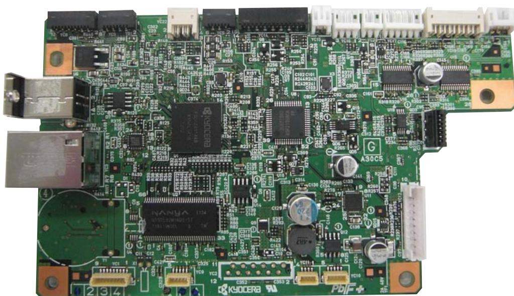
图 2-3-6 3 合 1 25/26 ppm 机型主控板
