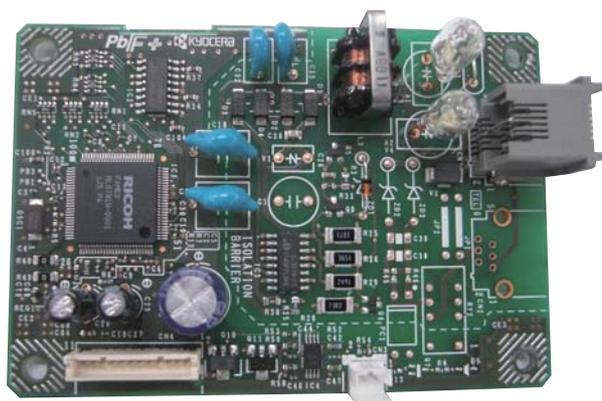
图 2-3-14 传真控制电路板
