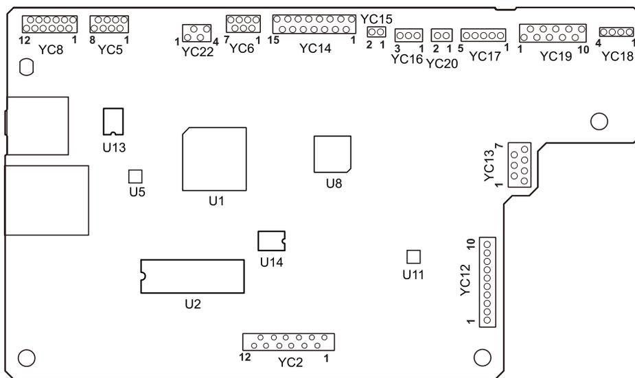
图 2-3-5 3 合 1 25/26 ppm 机型主控板丝印图
