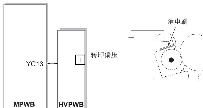
图 2-1-14 转印辊部框图
