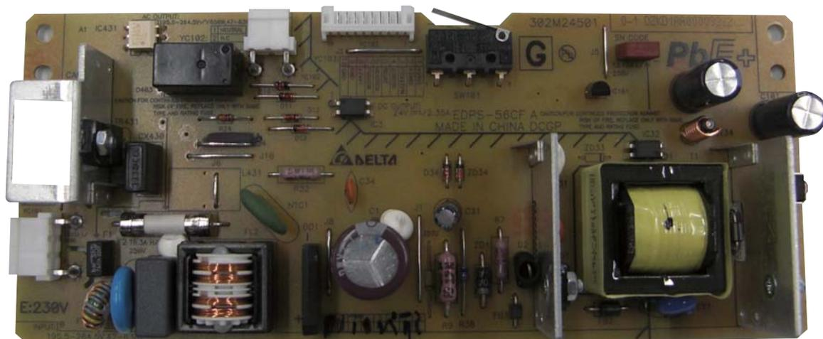
图 2-3-12 电源电路板
